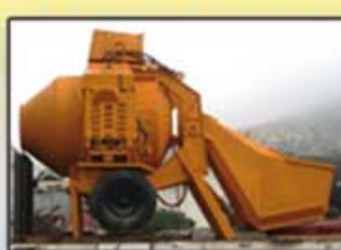
Bétonnière de chantier
